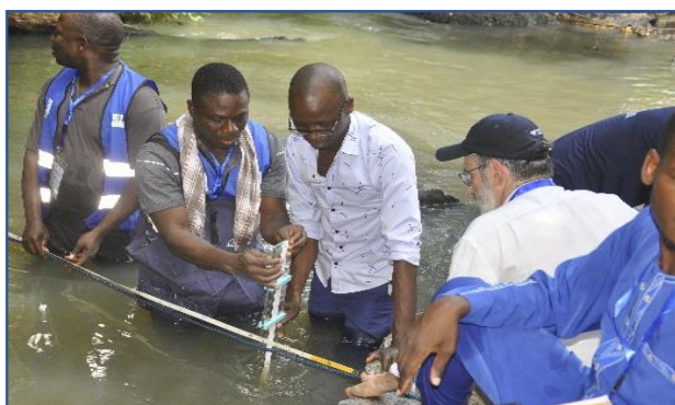
Photo 11 : technique de jaugeage avec la Perche à charge dynamique transparente
