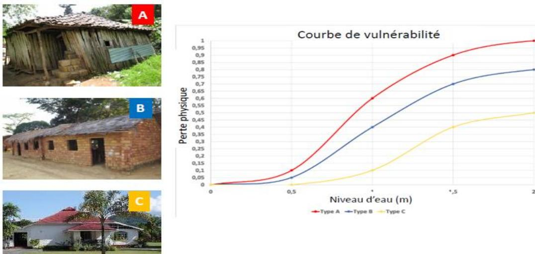
Figure 5 : Détermination de l'indice de vulnérabilité aux risques des inondations
